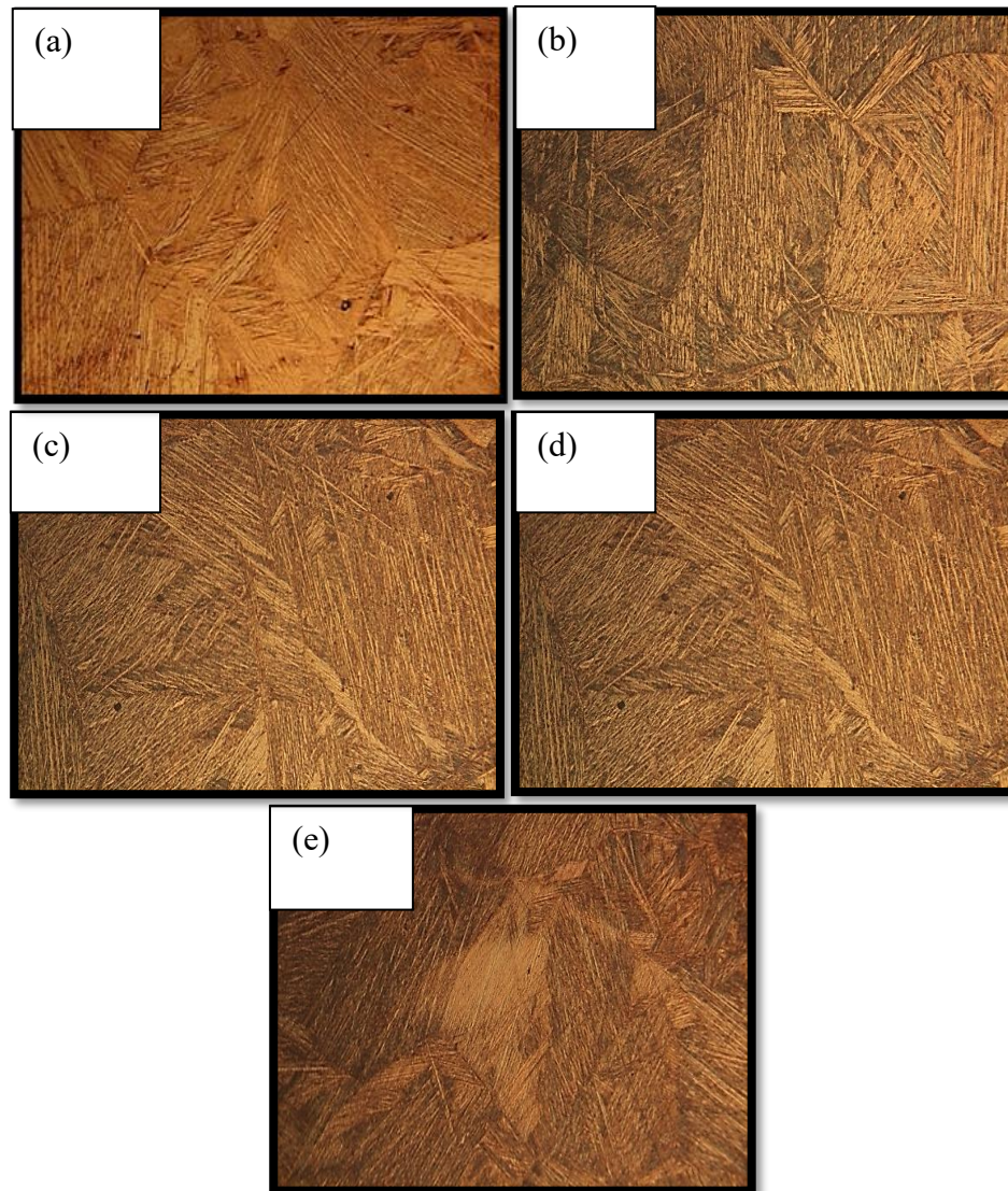
Figure 2 Optical micrographs of Cu–Al–Mn shape memory alloys with increasing Mn content: (a) CuAlMn1 (1 wt.% Mn), (b) CuAlMn2 (3 wt.% Mn), (c) CuAlMn3 (5 wt.% Mn), (d) CuAlMn4 (7 wt.% Mn) and (e) CuAlMn5 (9 wt.% Mn).
